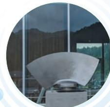
本名発電所で約60年稼働した水車ランナの6枚のブレード(羽)の1枚を実物展示しています。
